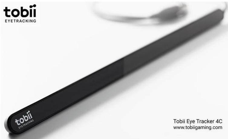
Berechnet aus der Reflexion infraroten Lichtes die Augenbewegungen und -positionen
